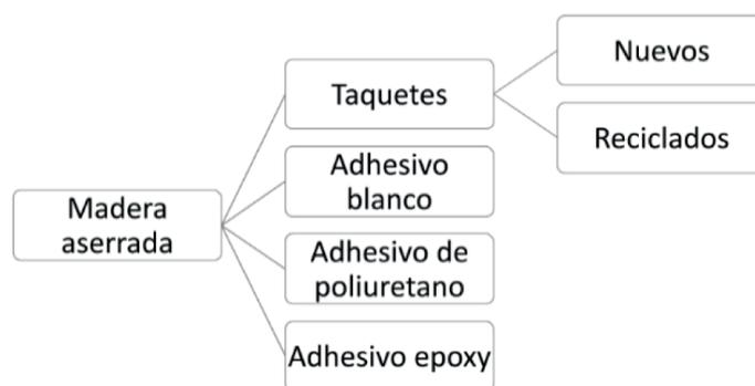
Figura 3. Combinaciones de fabricación de la viga laminada
